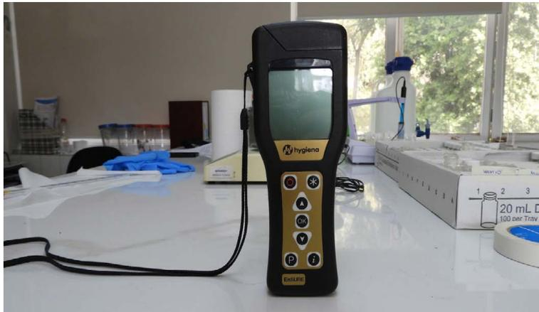
**Figura 4.** Luminómetro utilizado para cuantificar la señal de luz
