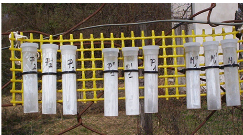
Figura 1: Juego de muestreadores por triplicado para \text{NO}_2 , \text{SO}_2 y \text{O}_3 .
