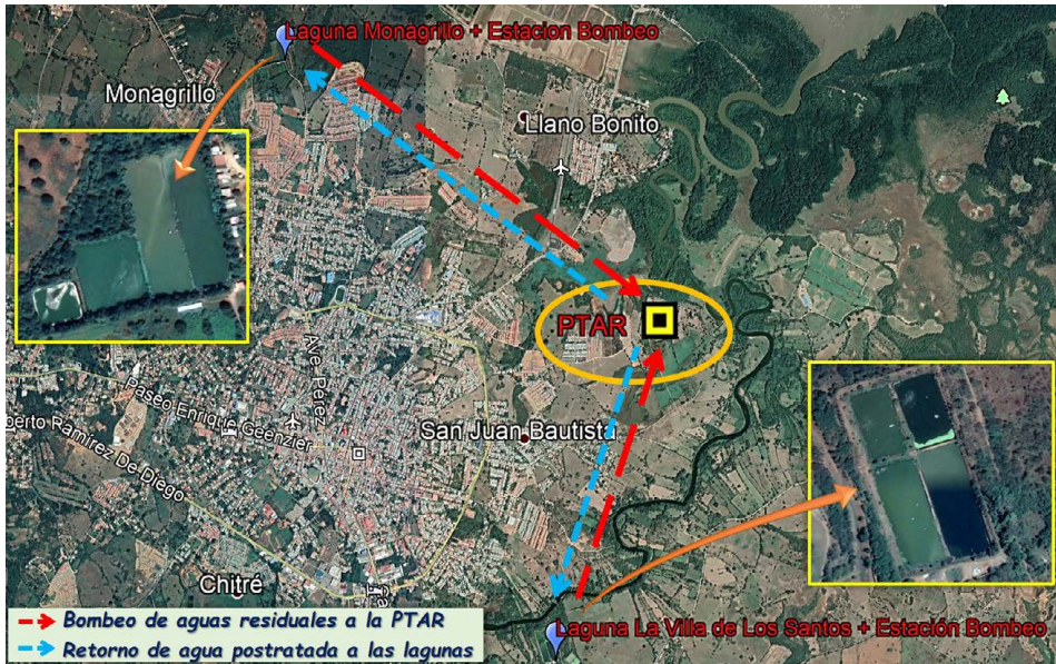
Figura 13. Diseño conceptual del mecanismo de adecuación de los efluentes de la PTAR para su posterior uso en riego y recarga de acuíferos
