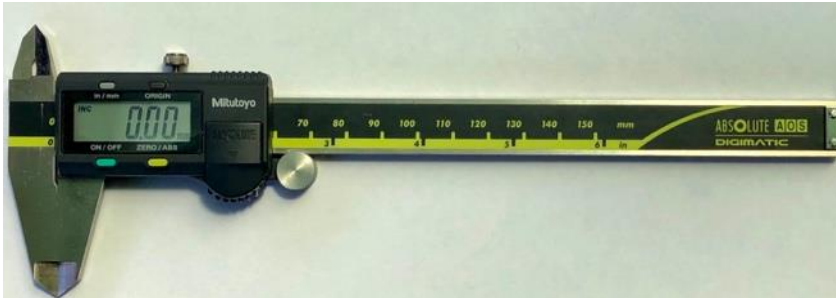
Figura 2. Calibrador Vernier o Pie de Rey digital.
